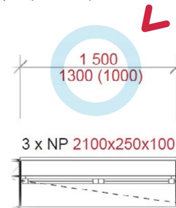
V prípade, že požadujete drobné zmeny v PD (rozmer okna, hrúbka muriva a pod.) je potrebné ich zreteľne zakresliť do výkresov (červenou) a v prípade rozsiahlejších zmien požiadať projektanta o úpravu PD v nevyhnutnom rozsahu, tak aby bola zaručená jednotnosť nápočtu s realizáciou.
